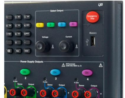
图 11. N6705 前面板上的 USB 端口
