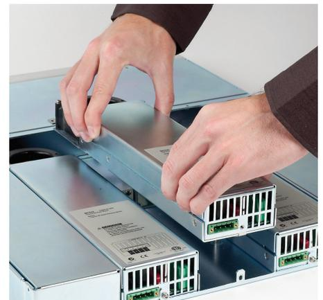
图 14d. 用户可重新配置的模块化系统
